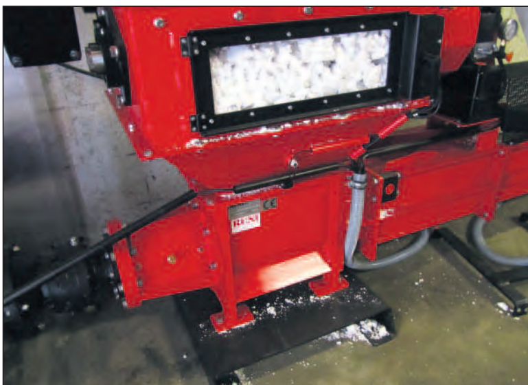
Geschreddertes Styropor im Sichtfenster der Anlage.
