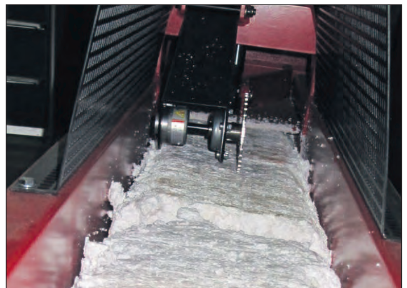
Gepresste Styroporbarren verlassen über das Vorschubrad die Anlage.
