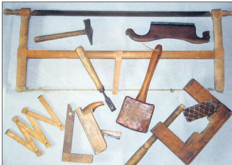
Der Schreiner des 19. Jh. sägte, hobelte die Bretter an der Werkbank von Hand zurecht, feilte, bohrte, schraubte, nagelte. Er erstellte Fälze, Nuten, Zapfen, Profile usw. Einige Werkzeuge sind hier abgebildet.
